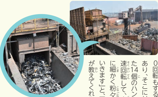
▲プレシュレッダーで砕かれた車体がぞくぞくと押し出されてきます
