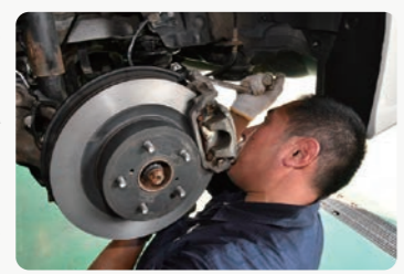
▲ディスクローター（タイヤの回転を止める部品）の交換にもリサイクル部品を使用することがあります
